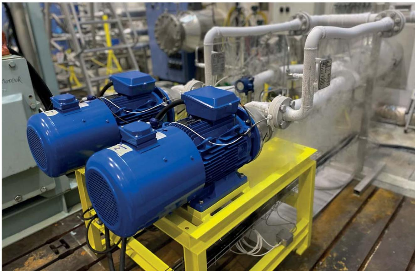
Les 2 pompes GBS en phase de test de résistance
